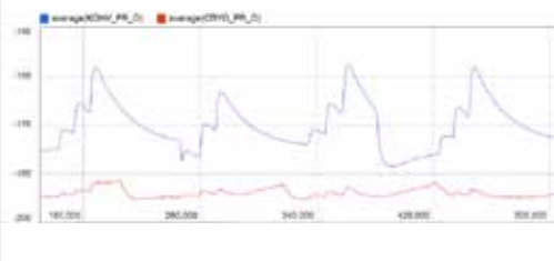
Fig. 3 Temperaturanstieg aufgrund von Ein- und Auslagerungsprozessen in benachbarten und nicht bewegten Proben
